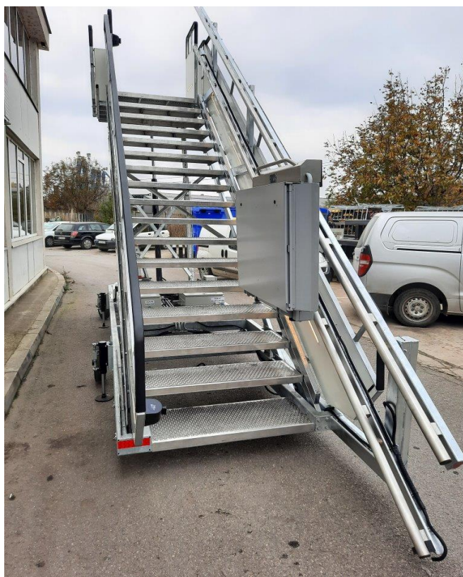
Nástupní schody do letadel – LETIŠTE.
